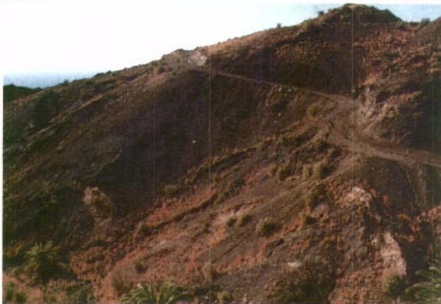
Foto 6.- Ejemplo de procesos erosivos asociados a desestabilización de ladera ocasionados por una pista de tierra. Valle de Alojera.
